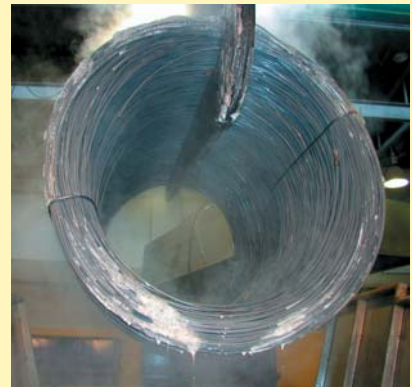
Obr. 2: Zvitok po morení v kyseline sírovej
