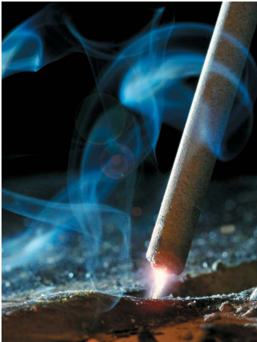
Obr. 1: Zapálenie oblúka. Snáď najfotografovanejší motív z oblasti zvárania. Tisíckrát rovnaký a predsa tisíckrát iný... Podobné rýchlostné fotografie zapalovania a horenia zváracieho oblúka sú inak dôležitým prostriedkom štúdia oblúkového procesu. Všimnite si ako z konca elektródy práve vyletela iskra.
