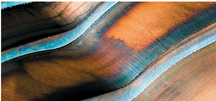
Obr. 4: Ocelové polia. Detail tvarových rezov hrubých ocelových plechov vyhotovených rezaním kyslíkom. Teplé farebné odtiene oxidov železa pripomínajú obrobenú pôdu pri pohľade z vtáčej perspektívy. Nakoniec snímok, ktorý pekne demonštruje autorovu schopnosť pozrieť sa osobitým pohľadom na veci, okolo ktorých my ostatní väčšinou len tak prechádzame.
