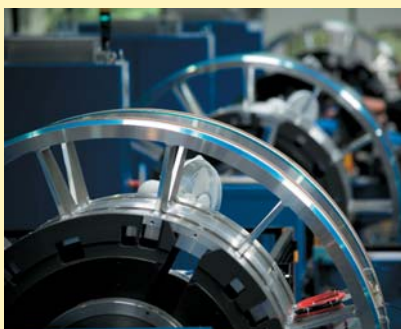
Obr. 2. Cievka supravodivého magnetu, ktorá sa ukladá na nádobu s héliom.
