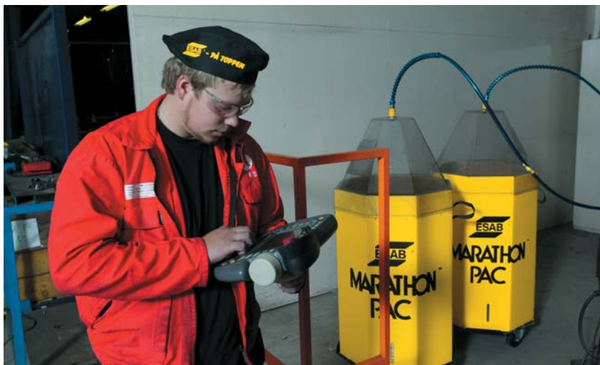
Obr. 3 Operátor programuje robot z priestoru mimo pracoviska.
